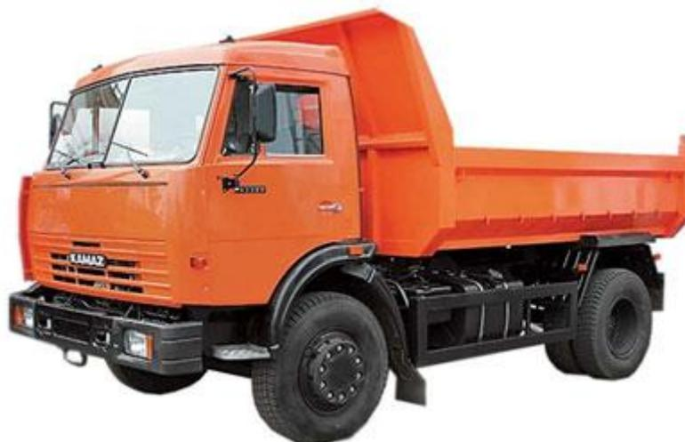
Грузоподъемность 7 тонн. Объем платформы кузова — 6 (6,5) м<sup>3</sup>
